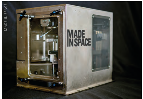
Seit 2014 auf der ISS: Der erste 3D-Drucker im All.
