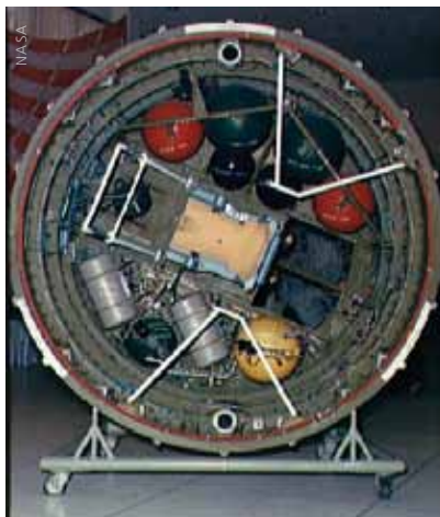
Die Anordnung des Rückentornister an der hinteren Seite der Gemini. Hier noch ohne die übliche Goldfolienverkleidung.
